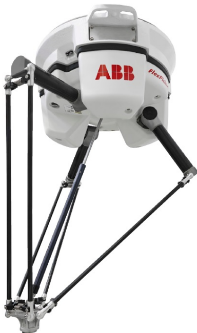
Abbildung 2.3: Flexpicker von ABB Automatics als annähernden Vergleich zum 3RUS
