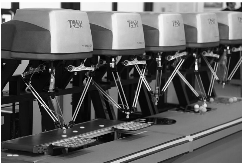
Fertigungsstraße mit mehreren Parallelrobotern.
